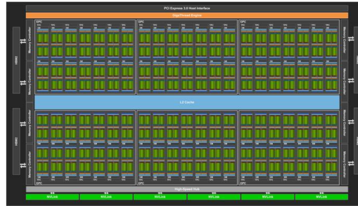
NVidia V100 = 84 процессора SM по 64 ядра CUDA = 5,376 ядер
