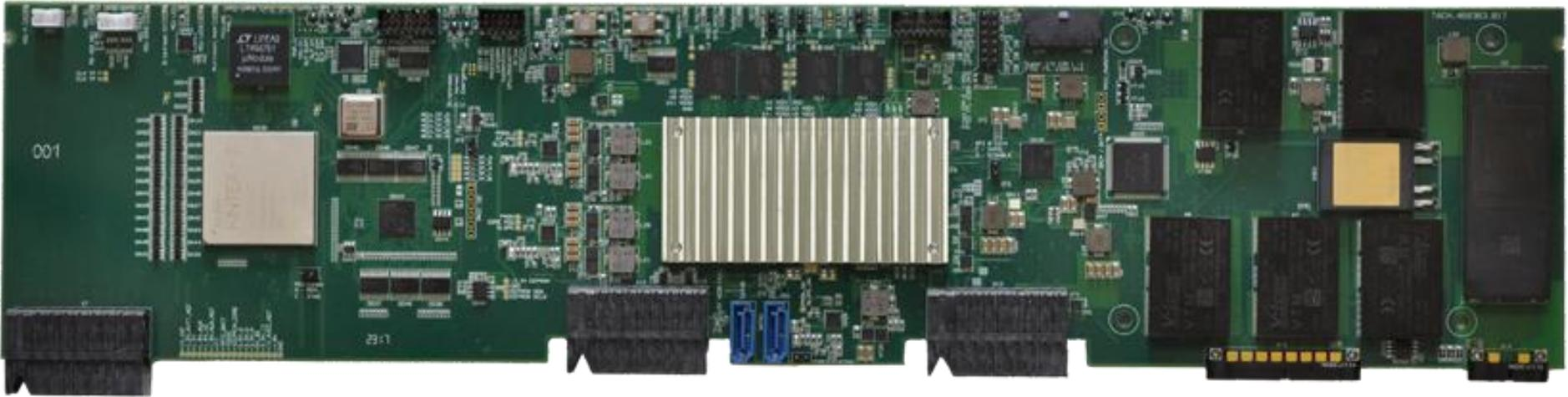
В НИЦ СЭ и НК разработана и произведена оригинальная материнская плата на основе процессора Intel Skylake® (Core I5-6300U) для вычислительного блока с жидкостным охлаждением.
