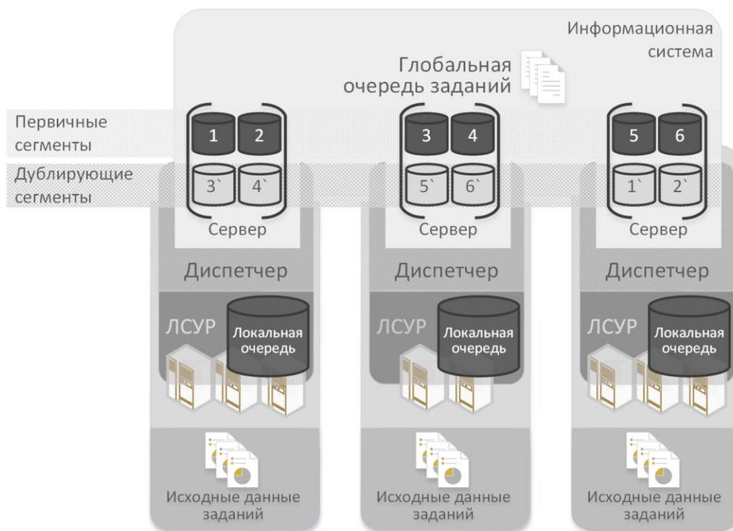
**Рис. 2.** Макет ТРС с использованием распределённой информационной системы на основе Elasticsearch
